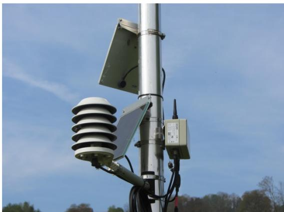
**Nahansicht des Masten mit Messgeräten, Solarpanels und Datenspeicher/-übermittler**
