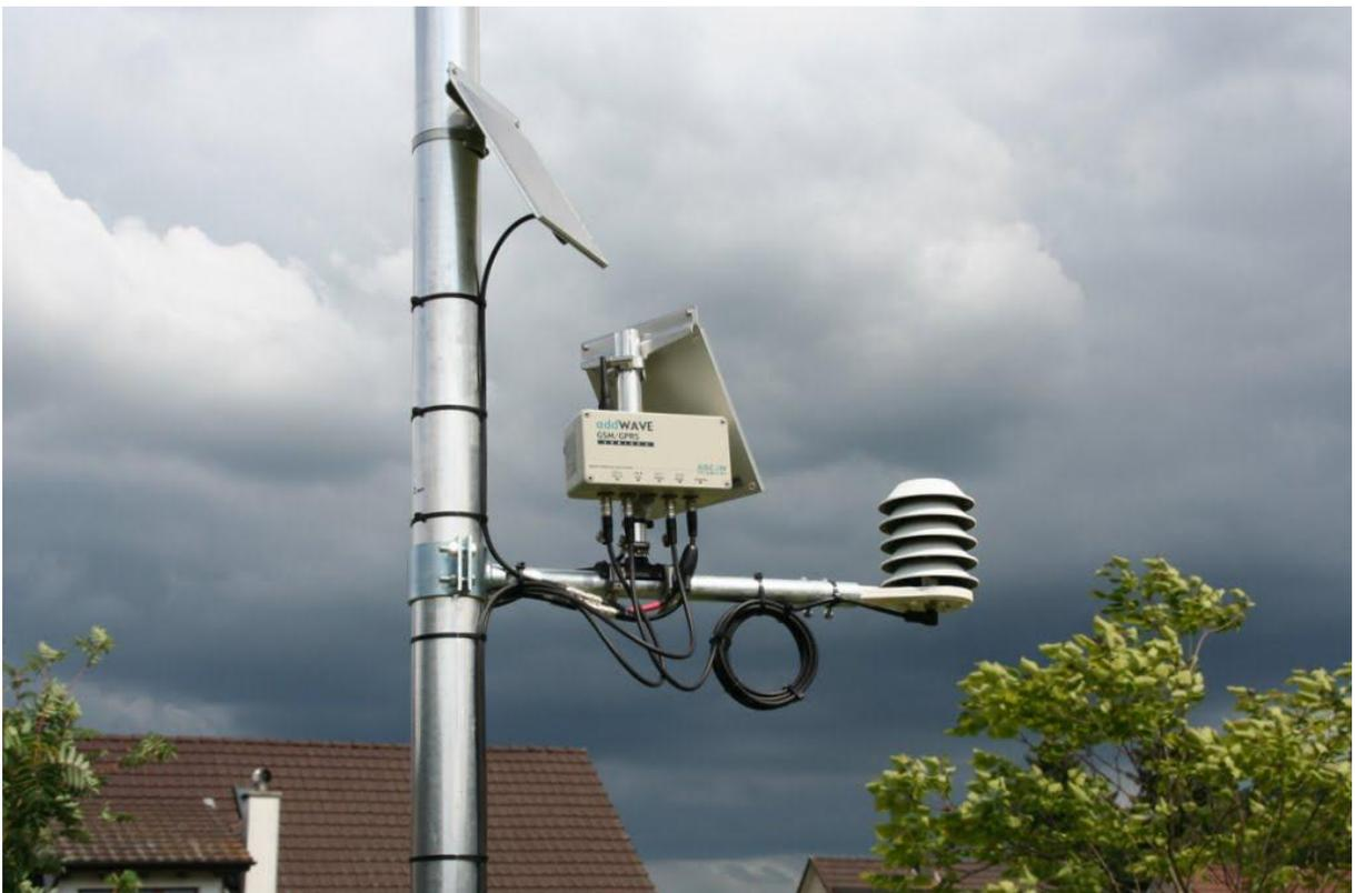
*GPRS-Sender, Solar-Panels und Vaisala-Sonde*
