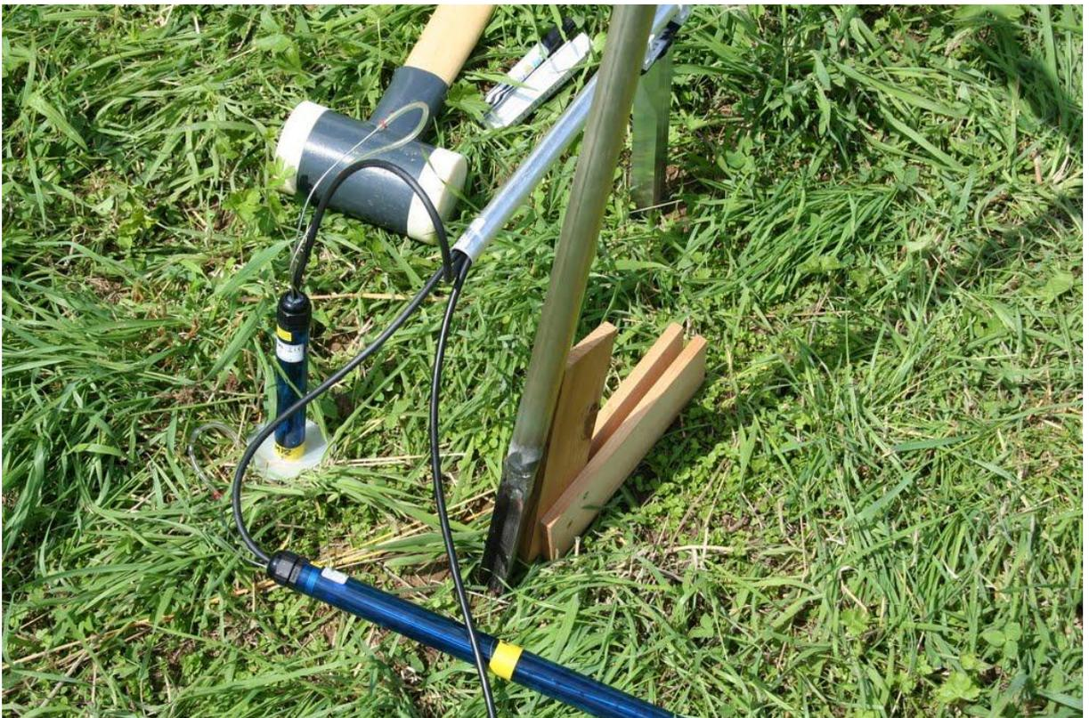
*Einbau der Tensiometer*
