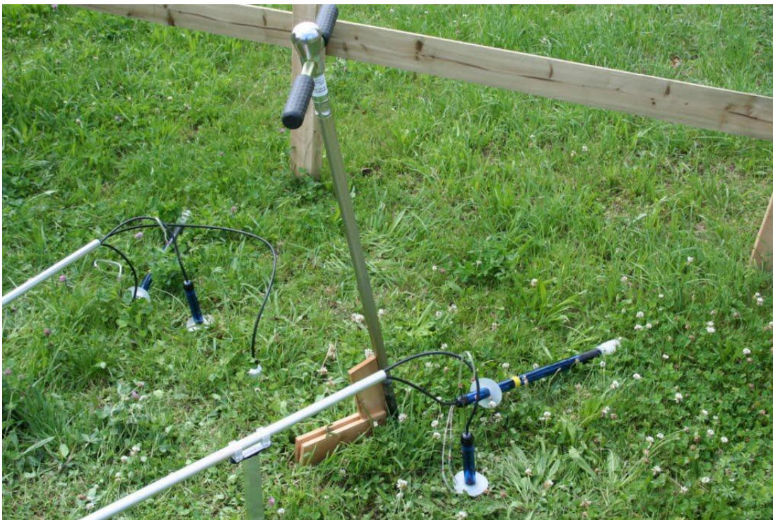
Einbau der Tensiometer in einem Winkel von 5°
